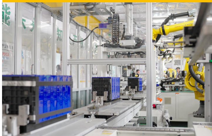
电芯模组自动化装配产线（南通生产基地）
