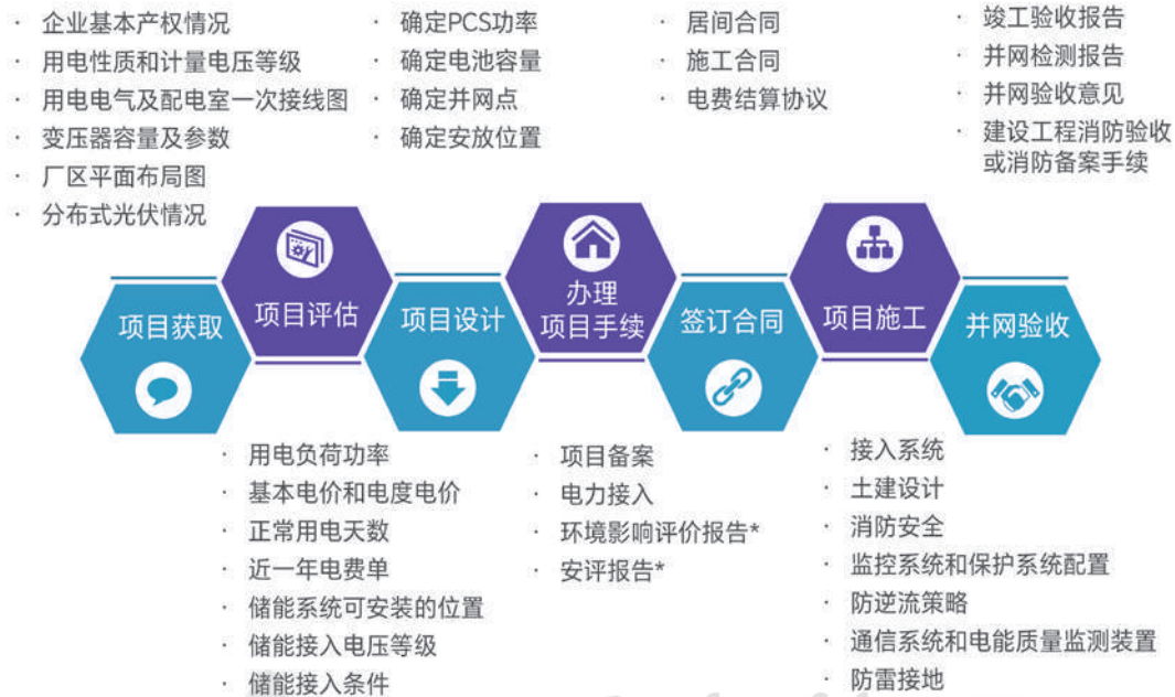
图 11 工商业储能项目的典型开发实施流程
